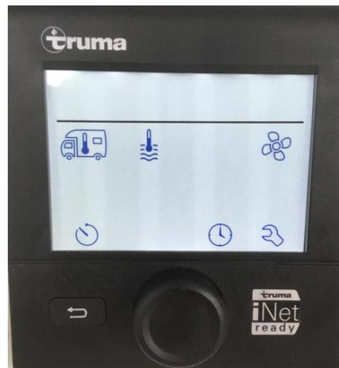
Um die Heizung wieder auszustellen, befolgen Sie den gleichen Weg. Dieses Mal drehen Sie den Drehknopf bis Sie „Off“ sehen. Bestätigen Sie durch Drücken des Drehknopfes. Bei Problemen der Heizung liegt eine detaillierte Beschreibung der Truma Heizung mit den anderen Bedienungsanleitungen im Fach unter dem Ofen in der Küche. Sie können auch das Personal vom Jachthafen um Hilfe bitten.
